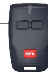
Nyní stiskněte na novém ovladači tlačítko, které chcete naprogramovat. Opět se rozsvítí červená LED dioda. Ovladač je nyní naprogramován. Počkejte cca 10s a opětovným stisknutím naprogramovaného tlačítka zkuste, zda ovladač uvede požadované zařízení do provozu, tedy zda proběhlo naprogramování v pořádku.
