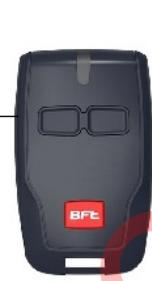
Opět na Vašem stávajícím ovladači stiskněte funkční tlačítko, tedy to tlačítko, kterým ovládáte Vaši bránu. Opět se rozsvítí červená LED dioda. Ovladač odložte a vezměte si ovladač nový, který chcete naprogramovat.
